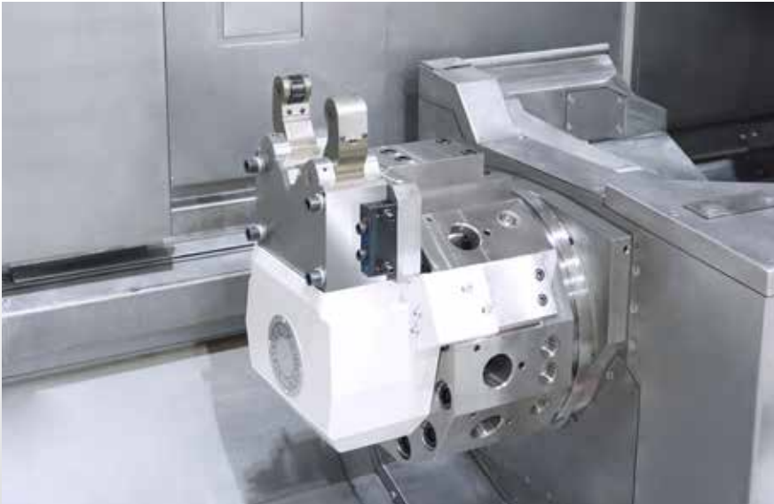
La rotation de la tourelle peut être réalisée avec la lunette (le nombre d'outils de montage est limité)
